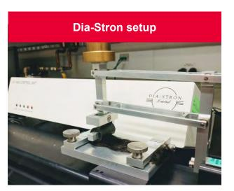
Dia-Stron MTT175 Tensile Tester
